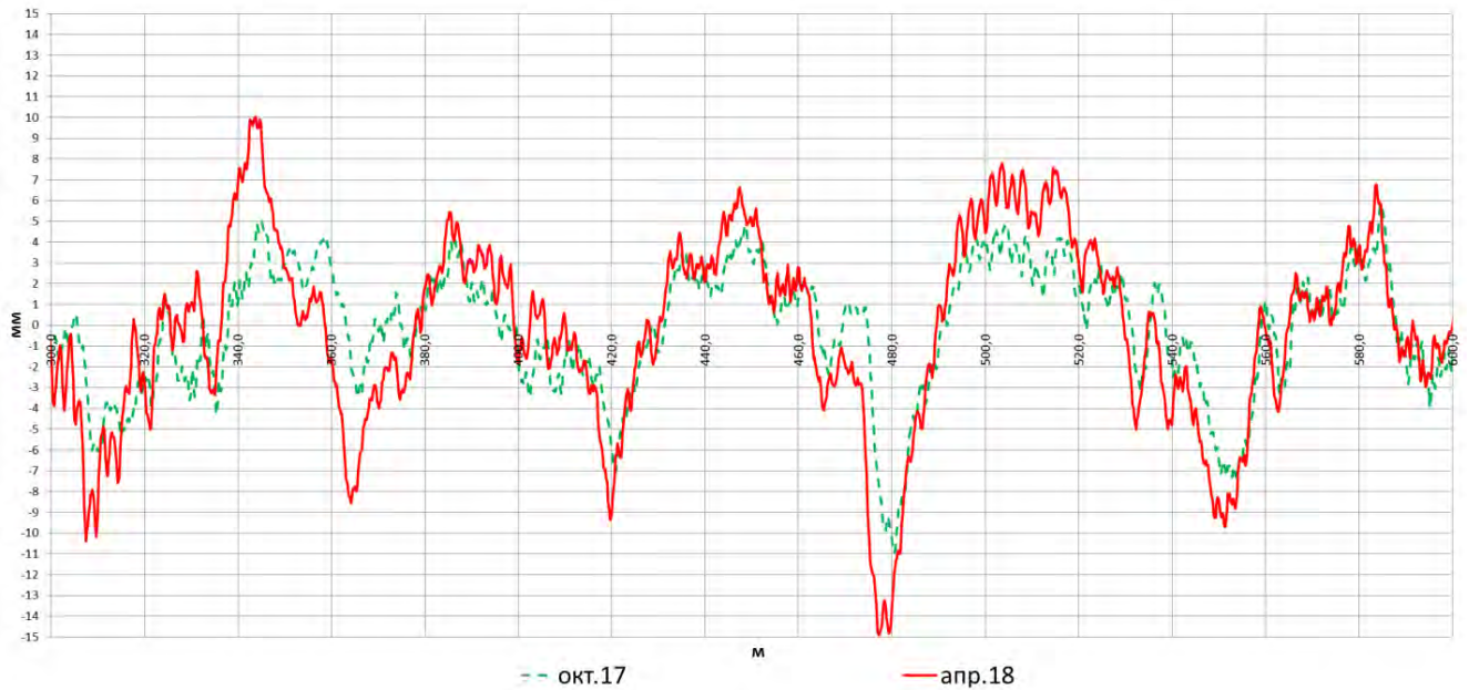
Рисунок 3.9 – Анализ данных неровностей в профиле пути на участке срабатывания датчиков КУХ 199 км по второму пути
